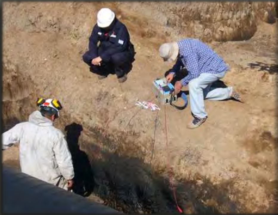
Mediciones en un suelo contaminado por petróleo crudo
